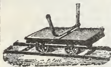
Wagon type 60, muni d'une fourche pivotante pour le transport des grands arbres.
